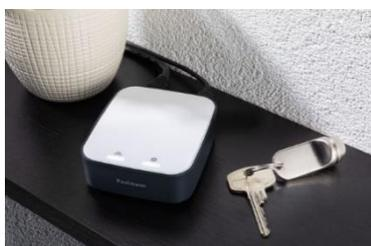
Die smik-Lichtsteuerung ist von Paulmann in Europa entwickelt. Das smik-Gateway ist mit Zigbee 3.0-Produkten kompatibel und hat Anti-Rutsch-Füße für eine sichere Positionierung sowie die Möglichkeit der Wandbefestigung.
